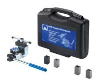
N° de pedido: 03.9310-0001.4 Refencia corta: 760012 Con el rebordeador doble profesional ATE se pueden rebordear de forma rápida y sencilla tubos de frenos según las formas de rebordeado F (DIN 74 234 / ISO 4038). Se pueden rebordear tubos de frenos con 4,75 + 6 + 8 + 10 mm de diámetro.
