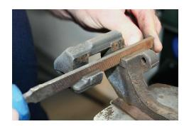
Con la lima para alojamientos de pinzas de freno ATE se puede sacar brillo metálico a las superficies guía de las pastillas en pinzas y soportes de freno. Puesto que sólo corta por una cara se evita dañar la caperuza de protección contra el polvo. Los bastos dientes especiales permiten un trabajo rápido y limpio.
