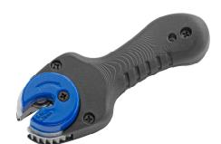
El cortatubos de carraca de ATE es una herramienta ideal para cortar profesionalmente tubos de freno con un diámetro de 4,75 mm. Gracias a su construcción compacta y a la función de carraca también es posible utilizarlo directamente en el vehículo, incluso en espacios reducidos. La función de reajuste automático suprime el pretensado de la rueda de corte durante el proceso de corte. Gracias al efecto de palanca adicional por la longitud del mango es necesario poco esfuerzo.
