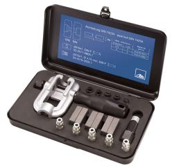
N° de pedido: 03.9310-0016.4 Refencia corta: 760155 El rebordeador manual ATE es un dispositivo económico con el que se pueden rebordear tuberías de freno con un diámetro de 4.75 mm, 5 mm y 6 mm rápida y sin complicaciones conforme a las formas E y F según DIN 74234 / ISO 4038.
