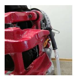
La manguera de purgado de 90° de ATE es un accesorio útil para el purgado en espacios reducidos. Dada su construcción compacta, el adaptador sólo ocupa 19 mm, permitiendo así la recogida del líquido de frenos en zonas de difícil acceso.
