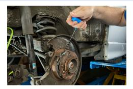
El gancho para resortes ATE es la herramienta perfecta para montar y desmontar los resortes de sujeción de las pastillas de freno.
