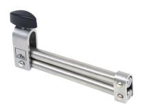
N° de pedido: 03.9310-0060.3 Refencia corta: 760028 La pinza para latiguillos de freno ATE se usa para estrangular latiguillos de freno durante la reparación de los frenos o la localización de averías. De este modo no se vacía el sistema de frenos durante las reparaciones de los frenos por separado. Para la localización de averías se puede desactivar el funcionamiento del freno de una sola rueda.
