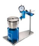
Con el dispositivo de medición de lo discos de freno ATE se puede verificar con precisión la planeidad de los discos de freno sin montar ( sin el asiento de cojinete ). Es posible de verificar discos de freno hasta un diámetro de 360 mm
