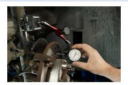
Las arandelas espaciadoras de ATE permiten una fijación rápida y segura del disco de freno al cubo de rueda. Con ayuda de tuercas originales de hasta M14 y tornillos cónicos o esféricos, el disco de freno podrá ser fijado con precisión sobre el cubo, dejándolo listo para la medición de la desviación axial o concentricidad.
