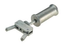
N° de pedido: 03.9314-6100.3 Refencia corta: 760073 El extractor por impacto de pastillas de freno se usa para extraer pastillas de frenos de disco atascadas con ojales de sujeción en las pinzas fijas. Éste evita los daños en las pinzas de freno y los discos. Gracias a la barra de tracción integrada en la pesa de impacto no existe riesgo de lesiones.
