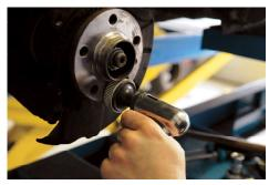
El juego de limpieza para bujes de rueda 4 de ATE es una herramienta ideal para la limpieza rápida, segura y económica de cubos de ruedas muy sucios u oxidados. Antes del montaje del disco de freno debe limpiarse la superficie de asiento del buje de la rueda hasta dejar el metal impecable. Solamente así se pueden mantener las tolerancias de montaje y evitarse el frotamiento de los frenos.
