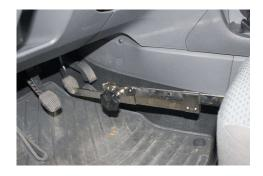
Para realizar las pruebas de estanqueidad en el sistema de frenos hidráulico es necesario ejercer una presión constante sobre el pedal de freno durante un período largo. Para la verificación o el ajuste de los reguladores o limitadores de la fuerza de frenado es necesario también ejercer una presión constante sobre el pedal de freno. La forma ideal de generar esta presión es con el inmovilizador de pedal ATE.
