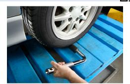
El comprobador de la suspensión es un instrumento sencillo y muy efectivo para localizar el juego del cojinete en el área de los ejes. Con la suspensión bajo carga, mediante el comprobador de la suspensión se puede localizar rápida y fácilmente el juego del cojinete en el cojinete de la pata telescópica / suspensión articulada / rótula de dirección / cojinete de rueda / rótula axial / mecanismo de dirección, etc.
