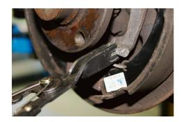
Con las tenazas de resorte para el cable del freno de estacionamiento ATE se pude colgar segura y cómodamente el cable del freno de estacionamiento en la palanca de las zapatas en frenos de tambor. Resulta especialmente útil para motar el ATE Top Kit.
