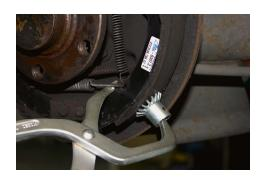
Con las tenazas para resortes de freno ATE (medianas) se pueden desmontar y montar de forma fácil y segura los resortes de retirada de las zapatas de freno en frenos de tambor. El platillo de apoyo articulado se apoya con sus afiladas garras sobre la superficie de los forros de freno. El gancho permite colgar el resorte de forma segura.
